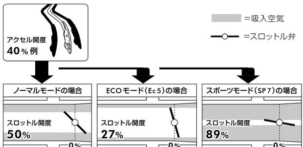
※バルブマチックエンジンなどを採用している一部車種では、スロットルバルブではなく吸気バルブで制御を行っている場合があります。
