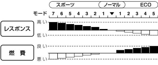
※ECOモードでは、純正状態よりもレスポンスを下げた低燃費走行が可能です。ただし、意図的に急加速運転をすると燃費は悪化します。
