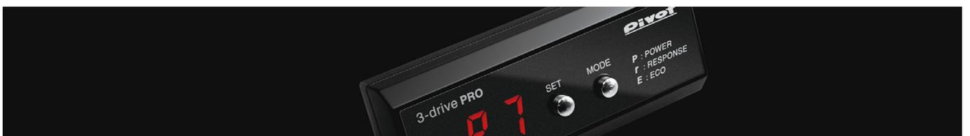
3-drive・PROは低電流回路の開発により、OBD等への電源接続を不要としアクセルコネクタへ
