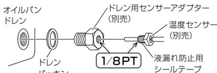
**⚠ 注意** 最低地上高の低いクルマや悪路を走行するクルマの場合、センサーが下方向に突起するような取り付け方をすると、地面等に接触し破損・故障の原因となりますので別の場所へお取り付けください。
