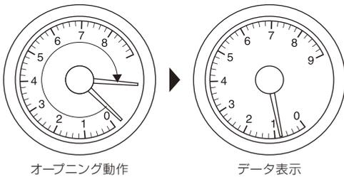
エンジン停止 ▶ 針がAの位置へ移動しイルミ消灯後にBへ移動。
