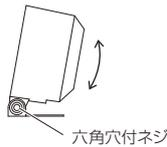
③ メーターにクッションテープを貼り電源コードを接続しメーターホルダーに差し込む。
