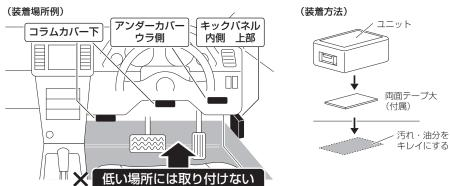
●コントローラーの取り付け 操作しやすい場所に、両面テープで固定してください。
