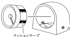
⚠ タップネジは、ステアにネジ山を形成しながら締めますが、強く締めすぎてネジが締まらなくなった時は付属のナットとワッシャーで固定してください。
