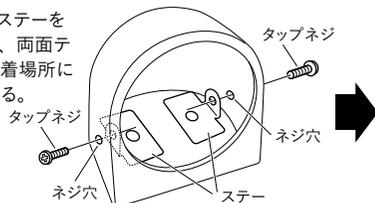
ステアの底面に両面テープを貼り固定する
