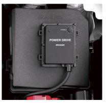
ヒューズボックスカバーに貼り付ける場合は下図のように両面テープを貼り、剥がれないように装着してください。
