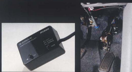
取り付けは、アクセルペダルに設けられたカプラーに配線を割り込ませる形。電源もカプラーオンで踏み潰されても破壊されないほどの高強度を持たされるほどだ。
